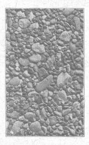
Si une surface de béton doit être enduite pour une raison quelconque, le traitement au Contex fournira la base garantissant l'adhésion parfaite de l'enduit.
