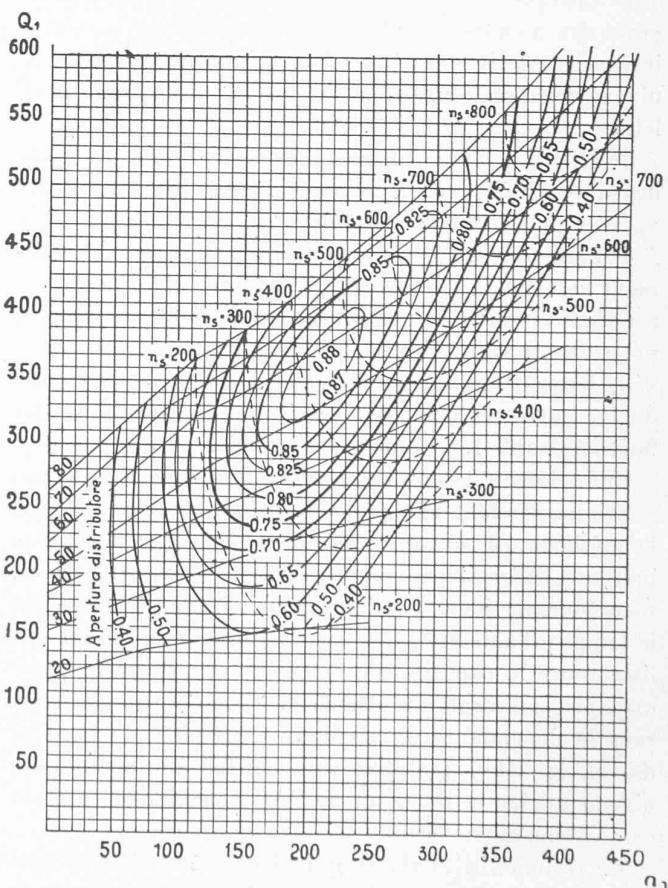
Fig. 5. — Diagramme «topographique» d'une turbine-hélice Riva, à 4 pales.
