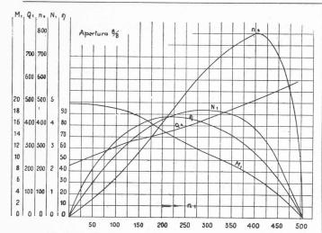
Fig. 2. — Caractéristiques d'une turbine-hélice Riva, à 4 pales, pour un degré d'ouverture de  $^6/_8$ .
