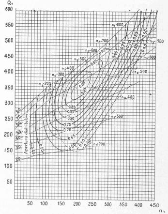
Fig. 5. — Diagramme «topographique» d'une turbine-hélice *Riva*, à 4 pales.
