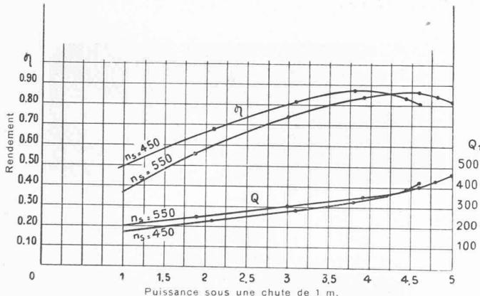
Fig. 3. — Rendement et débit d'une turbine-hélice Riva en fonction de la puissance développée sous une chute de 1 m., pour deux valeurs du nombre de tours spécifique.
