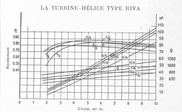
Fig. 4. — Rendement, puissance et débit, à vitesse constante et chute variable pour divers degrés d'ouverture d'une turbine-hélice Riva.
