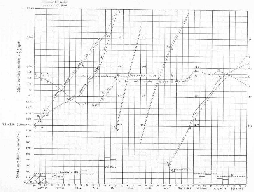
Fig. 3. — Application de la courbe intégrale à l'étude des lacs-réservoirs. — Lac Léman en 1924. Echelles du graphique original: Temps, 1 mm. par jour. — Débits instantanés, 1 mm. pour 10 m³/sec. — Courbe limnimétrique, ¹/30.
