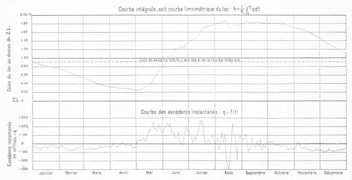
Fig. 2. — Application de la courbe intégrale à l'étude des lacs-réservoirs. — Lac Léman en 1921. Echelles du graphique original : Temps, 1 mm. par jour. — Débits instantanés, 1 mm. pour 10 m³/sec. — Courbe limnimétrique, 1/20.
