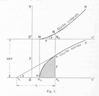
la tangente N T au point N de la courbe intégrale est parallèle à la directrice correspondante  $n_1n$  de la courbe donnée: c'est sur cette propriété fondamentale que repose la construction de *l'intégraphe*, qui trace mécaniquement la courbe intégrale d'une courbe quelconque.
