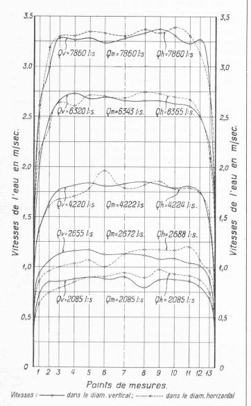
Fig. 5. — Courbes des vitesses dans une des conduites de la fig. 3, relevées au moyen d'un dispositif selon fig. 2.
