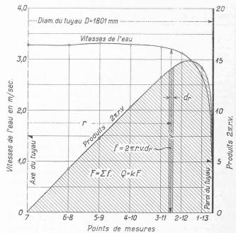
Fig. 6. Procédé de calcul du débit de la conduite d'après les courbes des vitesses, fig. 5.  $Q_m = 7\,860 \text{ l/s}.$
