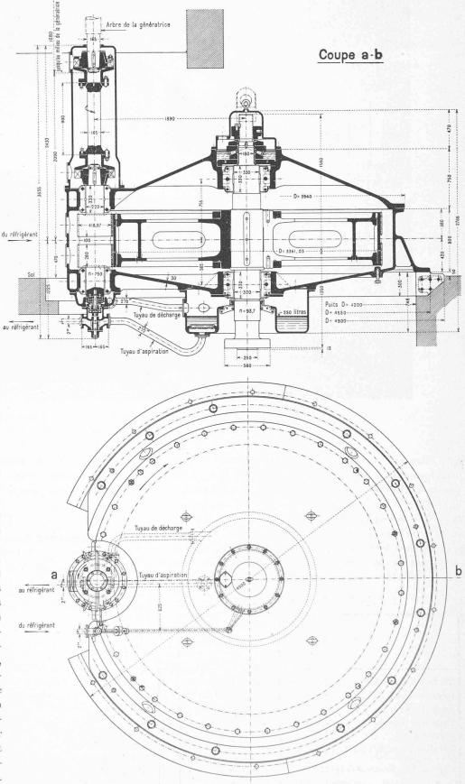
Fig. 1. — Plan et coupe de la transmission par engrenages Krupp de l'usine hydroélectrique de Hohenstein. — Echelle 1 : 40.
