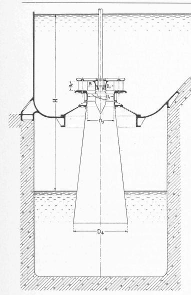
Fig. 1. — Turbine à hélice expérimentée à la station d'essais de la Société Escher, Wyss &  $C^{ie}$ , à Zurich.
