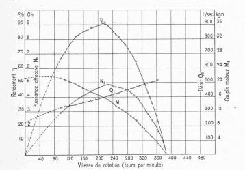
Fig. 7. — Turbine à hélice A. Caractéristiques pour une chute de 1 m. et un degré d'ouverture de 75  $^{0}/_{0}$ .
