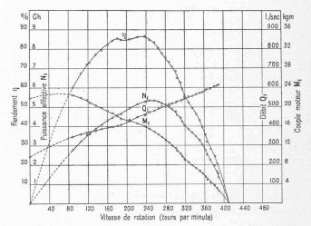
Fig. 8. — Turbine à hélice A. Caractéristiques pour une chute de 1 m. et un degré d'ouverture de 88  $^0/_0$ .
