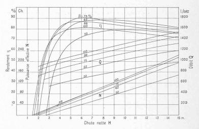
Fig. 13. — Turbine à hélice A. Variation du rendement, de la puissance et du débit en fonction de la hauteur de la chute, pour divers degrés (β) d'ouverture du distributeur et à vitesse angulaire constante (520 t/min.).
