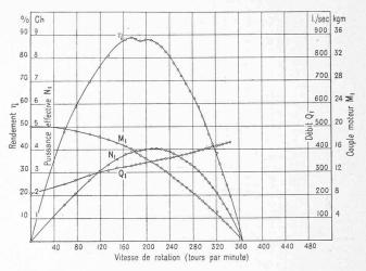
Fig. 6. — Turbine à hélice A. Caractéristiques pour une chute de 1 m, et un degré d'ouverture de  $62\,{}^0/_0$ .
