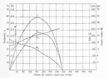
Fig. 5. — Turbine à hélice A. Caractéristiques pour une chute de 1 m. et un degré d'ouverture de 50  $^{9}/_{0}$ .
