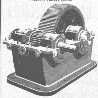
Pignon avec dents cémentées et rectifiées. Roue avec dents rabotées 16 réducteurs livrés à une fabrique de ciment en Belgique.
