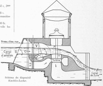
Le dispositif décrit ci-dessus a été adopté pour l'Usine hydro-électrique de Kembs, sur le Rhin, qui formera le premier tronçon du Grand Canal d'Alsace. Les vannes automatiques V (voir figure) seront réglées de manière à laisser passer toujours le même débit à travers le bâtiment des turbines, même quand celles-ci seront totalement ou partiellement fermées.
