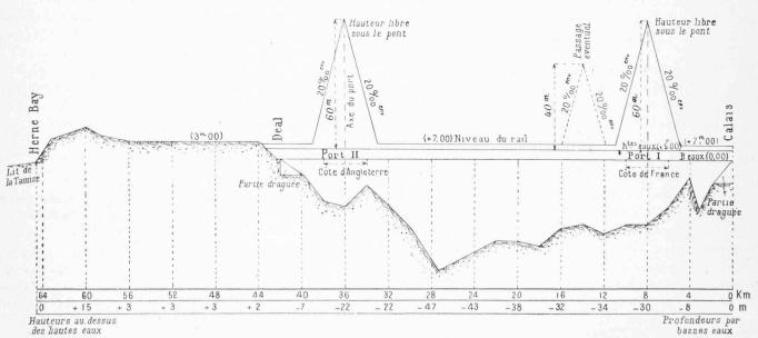
Fig. 2. — Profil en long du tracé du projet de M. Jaeger.
