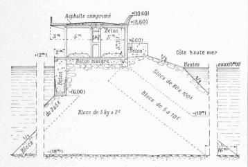
Fig. 8. — Coupe transversale du type de jetée (enrochements) correspondant aux petits fonds.
