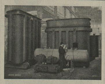
Cuves de transformateurs de grande puissance soudées électriquement à l'aide de groupes électroegènes construction Brown-Boveri.
