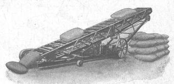
Monte-sacs transportable à commande électrique.
