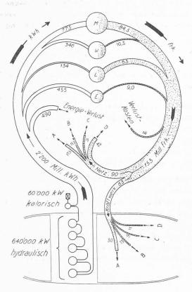
Fig. 1. Production d'énergie et recettes correspondantes, en 1923. Puissance totale des récepteurs : 1 690 000 kW.
