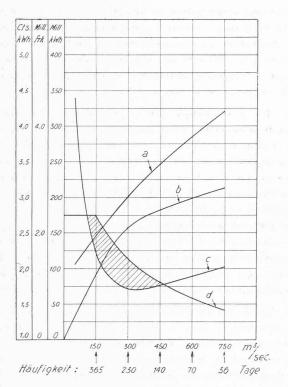
Fig. 3. — Quantité, prix de revient et valeur marchande, en fonction de la puissance installée, de l'énergie produite par une usine située sur un cours d'eau alpin.
