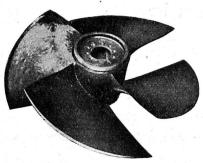
Roue à hélice d'une des 4 turbines de 2500 ch. chacune de l'usine de Wynau sur l'Aar.
