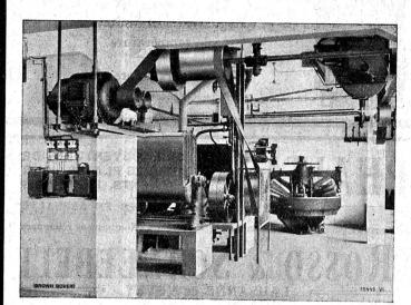
Commande d'une transmission par moteur à démarreur centrifuge. Le moteur étant fixé à une certaine hauteur, laisse le sol absolument libre.
