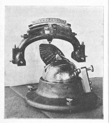
Fig. 1. — Le pendule Herbert pour la mesure de la dureté.
