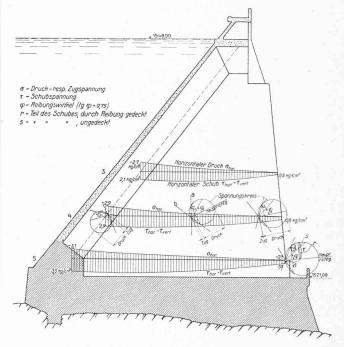
Fig. 14. — Actions moléculaires à l'intérieur d'un pilier.
