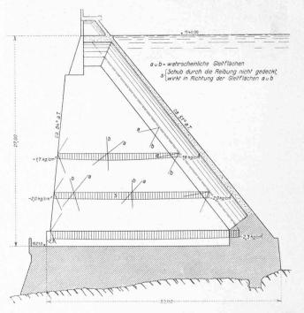
Fig. 18. — Sollicitation d'un pilier au cisaillement.
