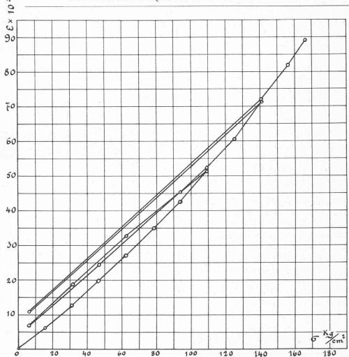
Fig. 6. — Détermination des déformations d'un prisme, en béton de ciment « électrique », sollicité à la compression.
