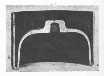
Fig. 4. — Culot de Bouteille Magondeaux, en fer électrolytique Bévé, emboutie à froid.
