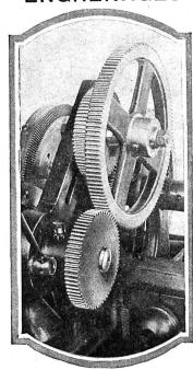
Le fonctionnement des engrenages métalliques produit un bruit énervant. L'engrenage en métal s'use rapidement; son fonctionnement produit un gaspillage de matériel et de force.
