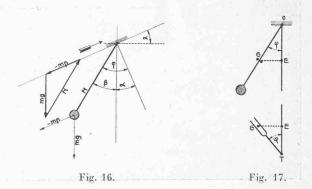
pente d'une rampe. D'après le principe de d'Alembert la force d'inertie — mp est en équilibre avec le poids mg et la tension de la tige du pendule N. Le triangle des forces donne alors la relation :
