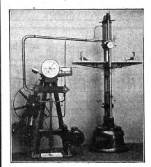
Machine universelle de traction de 10 tonnes.
