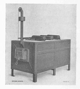
Four électrique à recuire les métaux, système B. B. C.
