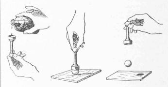
Fig. 1. — Détermination de la viscosité par le viscosimètre Michell. (Méthode d'atelier.
