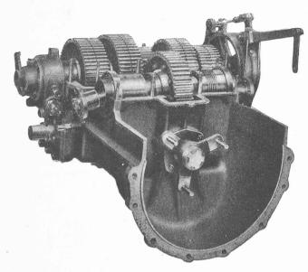
Fig. 4. — Application du changement de vitesse S. L. M. à un camion-automobile.
