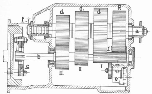
Fig. 1. — Changement de vitesse, système S. L. M.
