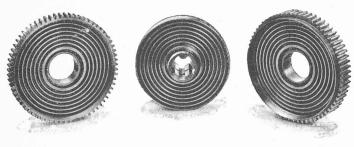
Fig. 3. — Disques à rainures circulaires du changement de vitesse S. L. M.
