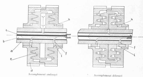
Fig. 2. — Schéma du fonctionnement du changement de vitesse S. L. M.
