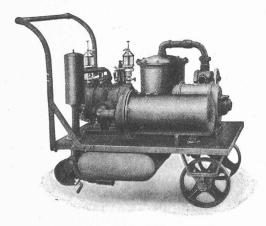
Fig. 7. — Petite installation transportable de compresseur accouplé directement avec un moteur électrique et muni de filtre d'air, refroidisseur d'air et séparateur d'huile.
