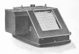
Fig. 5. Appareil enregistreur à 3 couleurs.
