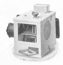
Fig. 4. Hygromètre thermométrique avec ventilateur.
