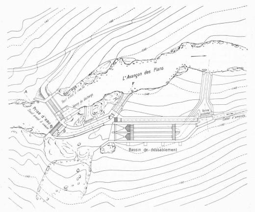
Fig. 2. — Plan du barrage et de la prise d'eau. — Echelle 1 : 600.
