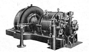
Turbo-soufflante de hauts-fourneaux, fournie aux Hauts-Fourneaux de Rouen (France).
