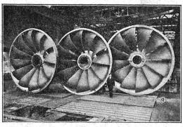
Roues des turbines de Chancy-Pougny (Suisse). Puissance 8700 CV sous 9 m de chute
