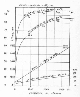
Fig. 10. — Caractéristiques de la turbine XI de Spiez (1923).  $H_n=62\,\mathrm{m.}$  —  $Q=4990\,\mathrm{l/sec.}$  —  $N=3500\,\mathrm{Ch.}$   $n=333\,\mathrm{tours/min.}$  —  $n_s=113.$
