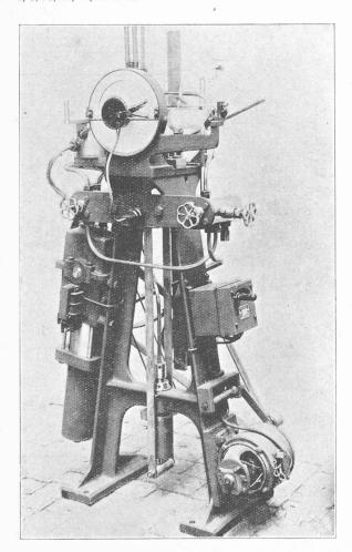
Fig, 1. — Dynamomètre à pendule, système Amsler avec dispositif pour le maintien de la constance de la charge. La pompe à cames est boulonnée sur le montant de gauche du bâti.
