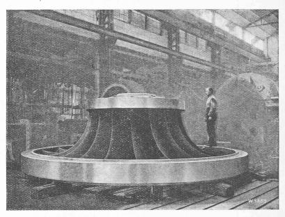
Fig. 2. — Vue de la roue motrice des turbines Escher-Wyss de l'usine de Chancy-Pougny.
