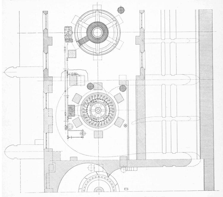
Fig. 1. — Plan d'installation des turbines de Wynau. — Echelle 1: 150.
