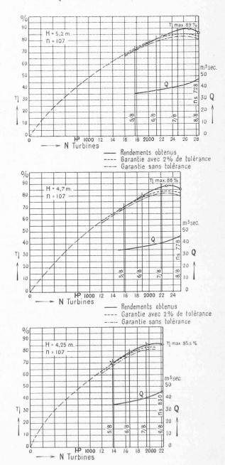
Fig. 6. — Diagrammes d'essais de réception.
