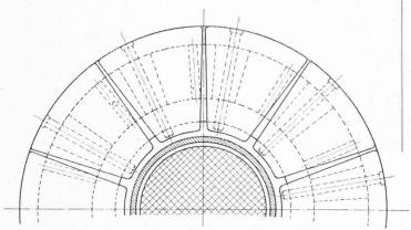
Fig. 4. — Vue par dessous des segments pivotants. — 1:25.
