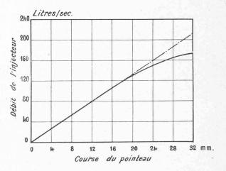
Fig. 7. — Débit d'un injecteur (Fully).
