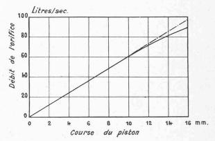
Fig. 5. — Débit d'un orifice d'essai (Bois-Noir).  $\mu = 0.652$
