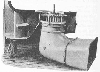
Fig. 11. — Turbine d'essai, à l'échelle 1:7, munie de son conduit d'évacuation et de sa bâche spirale.
