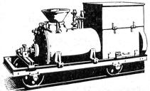
Machine à injection de ciment.
