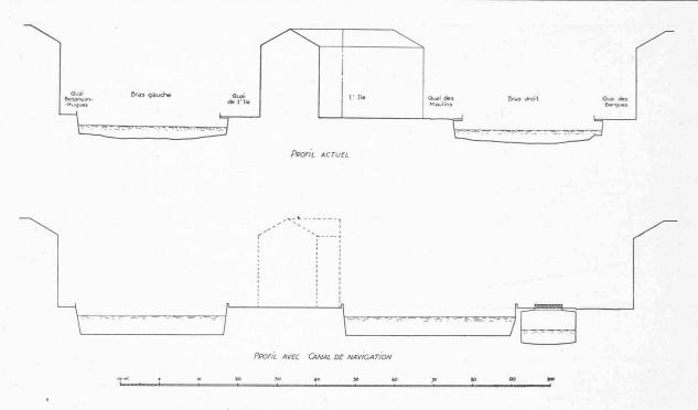
Fig. 3. — Profil en travers du Rhône.
