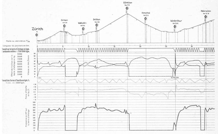
Fig. 43. — Wagon-dynamomètre des Chemins de Fer Fédéraux Suisses. Train 14 (3 mars 1914), locomotive A 3/5, No 608 à vapeur surchauffée, 106 tonnes (avec 2/3 d'approvisionnements); poids du train 374 tonnes, 45 essieux.
