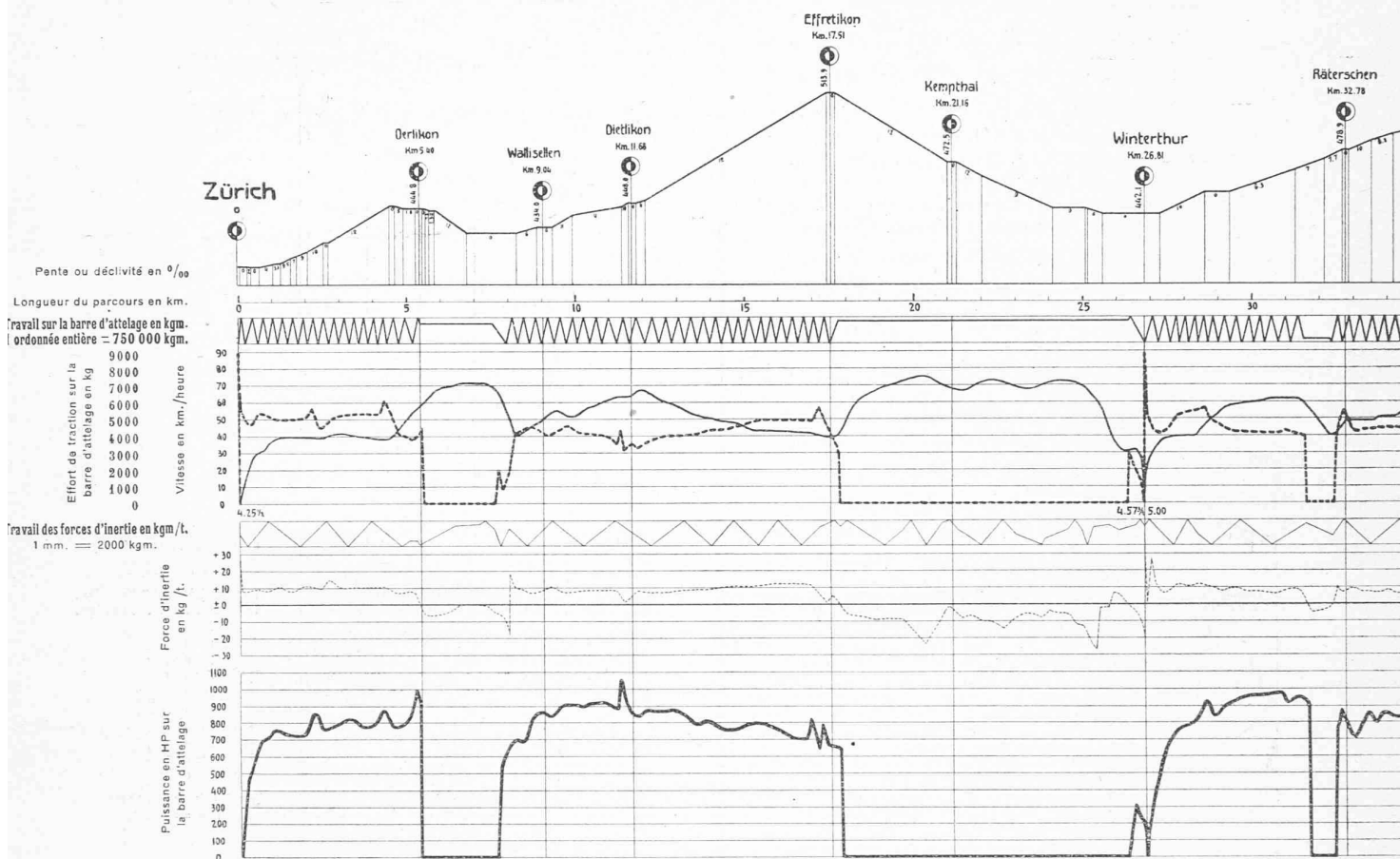
Fig. 43. — Wagon-dynamomètre des Chemins de Fer Fédéraux Suisses. Train 14 (3 mars 1914), locomotive A \frac{3}{5} , N° 608 à vapeur surchauffée, 106 tonnes (avec \frac{2}{3} d'approvisionnements) ; poids du train 374 tonnes, 45 essieux. Echelles du profil en long : longueurs 1 : 200 000, hauteurs 1 : 4000.
