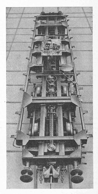
Fig. 42. — Wagon-dynamomètre des Chemins de Fer d'Etat de l'Ile de Java (voie étroite). Vue du châssis du wagon avec dynamomètre hydraulique et table des appareils.
