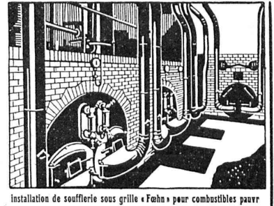
Installation de soufflerie sous grille « Föhn » pour combustibles pauvres
