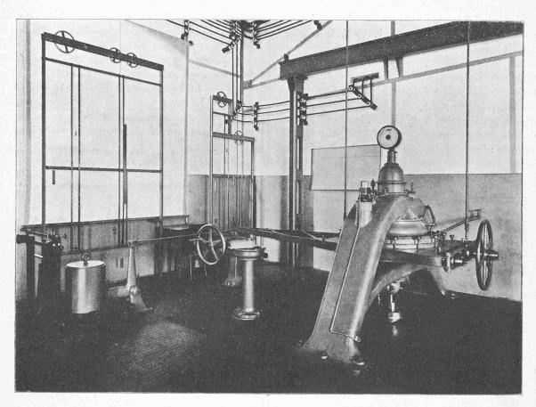
Fig. 6. — Frein, balance et indicateur de niveau, vus du poste de commandement. Au premier plan, sur le dos du chevalet, la petite dynamo-tachymètro.
