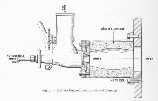
l'orifice de sortie du brûleur. La combustion échauffe la terre réfractaire qui, à son tour, rayonne sur le gaz et maintient la combustion (fig. 2).
