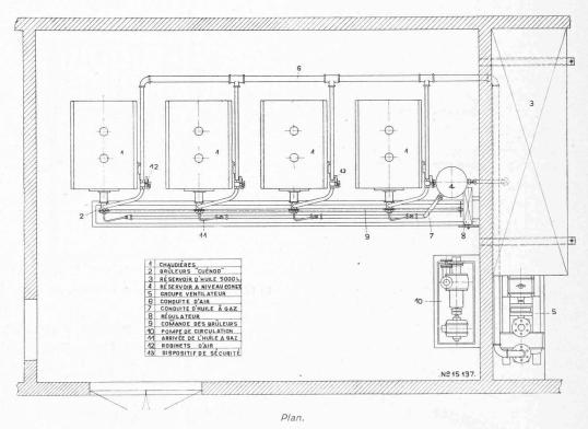
Fig. 3. — Disposition générale d'une installation de chauffage à l'huile à gaz.
