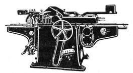
Machine à quatre faces pour roboter Demandez et moulurer Mod. DVS. catalogues et devis.
