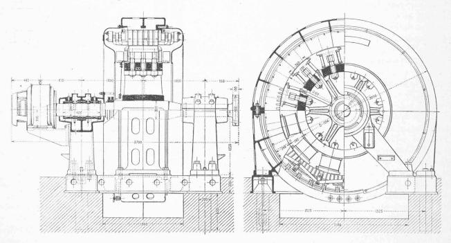
Fig. 45. — Alternateur de 2800 KVA, 500 tours, 10000 volts, 50 périodes. — Echelle 1:40.
