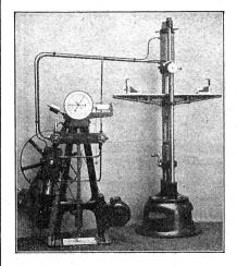
Machine universelle de traction de 10 tonnes.
