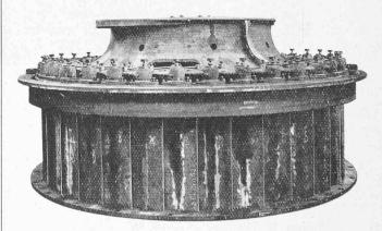
Fig. 3. — Distributeur et commande du vannage de la turbine de 2500 chev. de l'usine de Mauzac.
