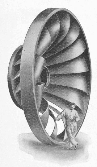
Fig. 2. — Roue motrice à grande vitesse des turbines de l'usine de Mauzac sur la Dordogne.
