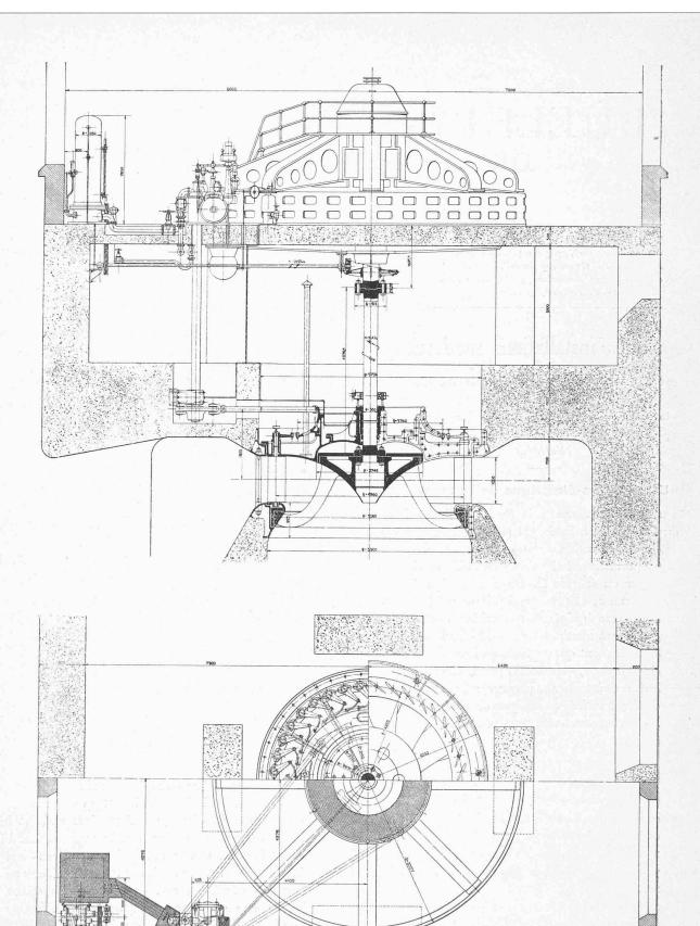
Fig. 1. — Turbine Francis de l'usine de Mauzac (France) construite par les «Etablissements Leflaive S. A.,» à Saint-Etienne, et les «Ateliers de Constructions Mécaniques de Vevey».
