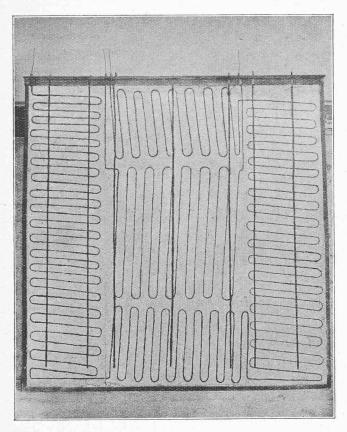
Fig. 3. — Corps de chauffe électrique.
