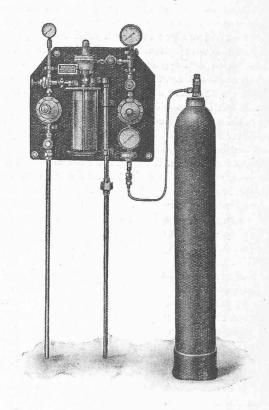
Fig. 2. — Appareil Ornstein de puissance moyenne. Débit: 5 à 100 gr. de chlore à l'heure. (Dispositif pour établissement de bains.)
