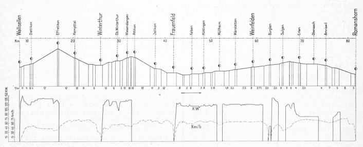
Fig. 9. — Profil en long de la ligne Wallisellen-Romanshorn sur laquelle ont été effectués les essais de l'automotrice Sulzer.
