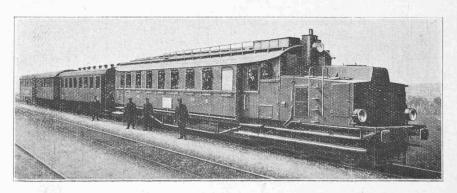
Fig. 6. — Automotrice Sulzer, à moteur Diesel.
