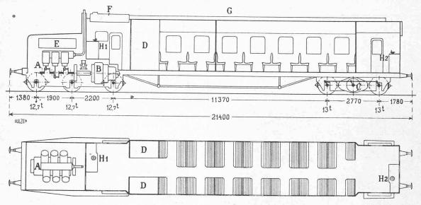
Fig. 2. — Coupes longitudinale et horizontale de l'automotrice Sulzer à moteur Diesel.
