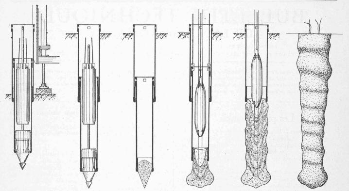
Fig. 1. — Phases de la confection d'un pieu Franki (système A).
