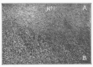
Fig. 1. Soudure « Quasi-Arc » typique.
