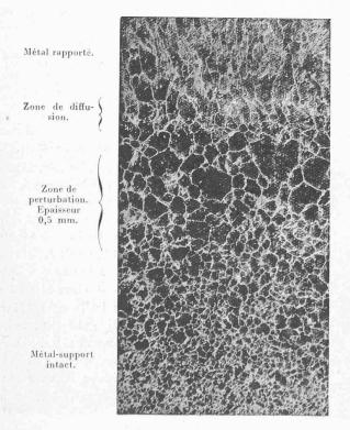
Fig. 3. — Soudure électrique « Quasi-Arc ». (Grossissement: 50).
