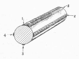
Fig. 6. — Schéma de l'exécution du renforcement d'un arbre par le procédé « Quasi-Arc ».
