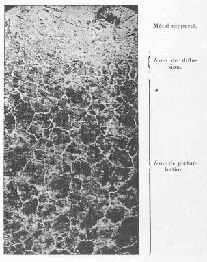
Fig. 4. — Soudure oxy-acétylénique. (Grossissement : 50).
