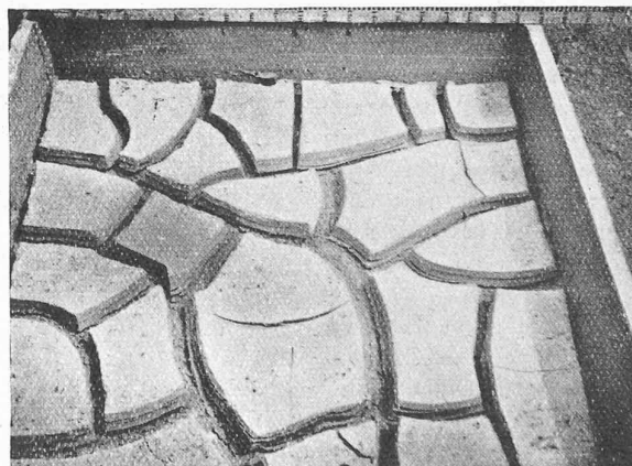
Fig. 12. — Auge en béton. Terre glaise complètement desséchée.
