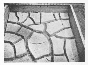
Fig. 12. — Auge en béton. Terre glaise complètement desséchée.
